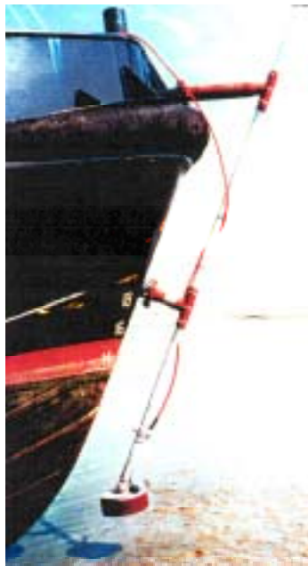
Типовая схема EM-3000 с одним или двумя вибраторами
