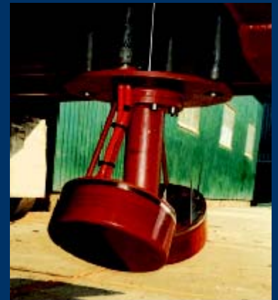
Пример установки двух вибраторного варианта на выдвижной штанге
